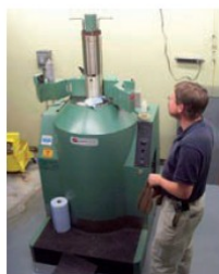
Ирадијатор за истражување и озрачување на материјали: Co-60
