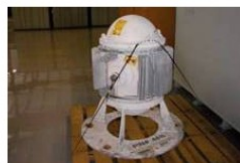
Радиоизотопни термоелектрични генератори: Sr-90 Pu-238
